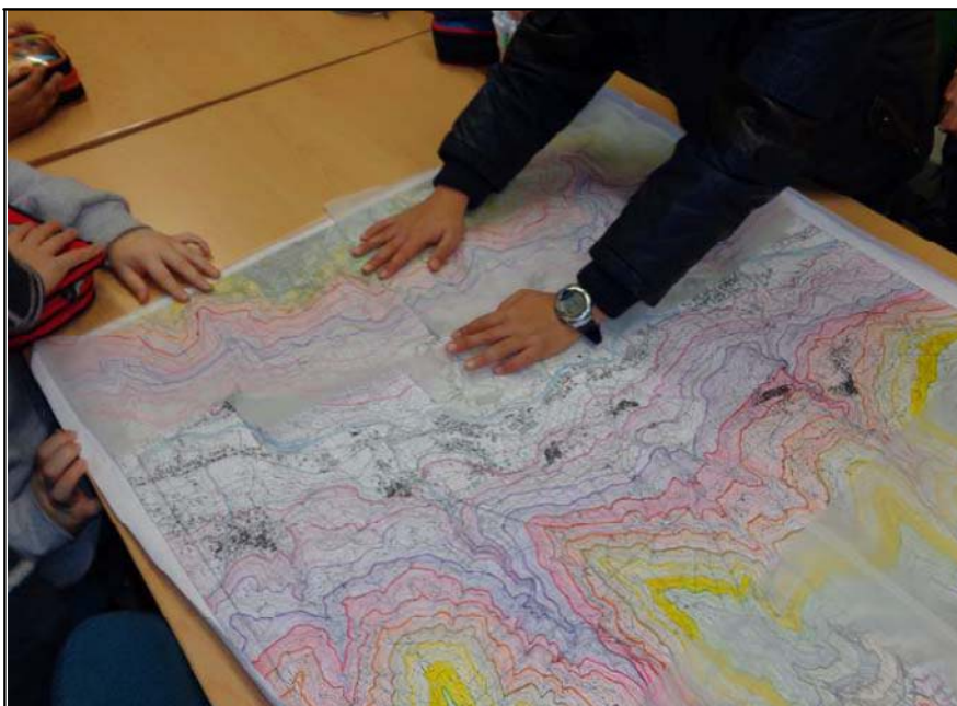
Fig. 1. Smontaggio della carta topografica: si tracciano le isoipse e si individua l'idrografia.
